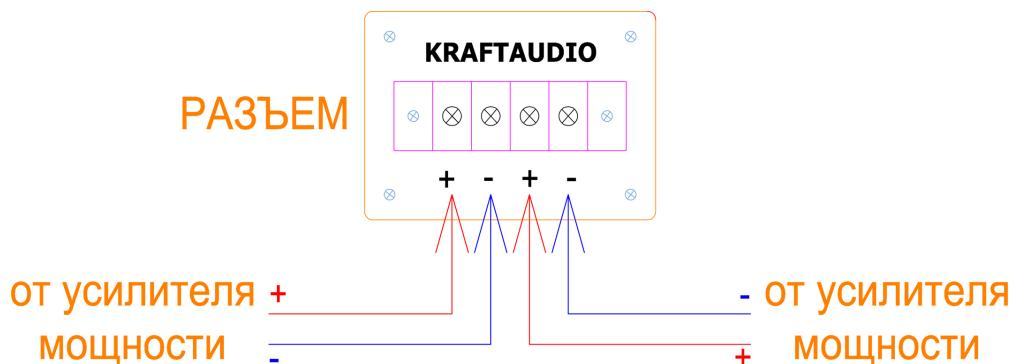
Следующий рисунок показывает назначение каждого из четырех контактов разъема, расположенного на боковой стороне низкочастотной акустической системы при присоединении одного усилителя:
